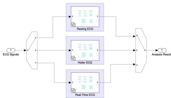
在 Simulink 中建模的心电图信号分析算法。
