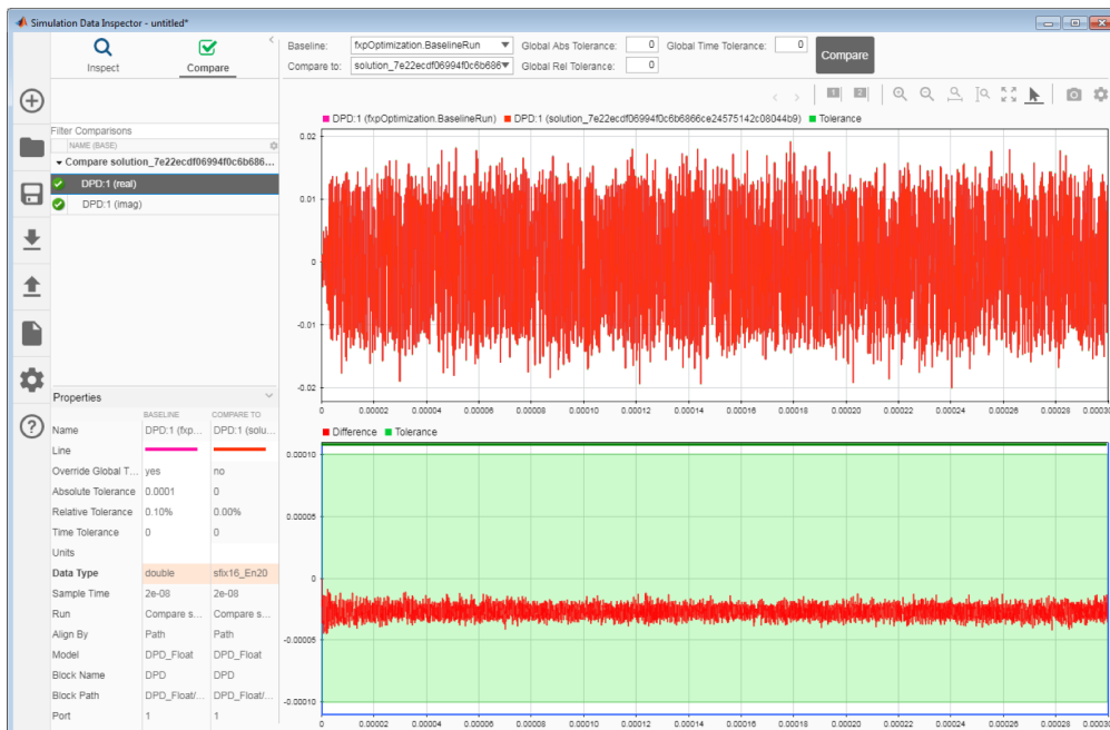
图 34: 错误信号图表示使用浮点精度和定点精度计算的 DPD 模块的输出信号仿真结果之间的差异。
